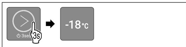
Fig. 37 Příkladné zobrazenie v závislosti od vopred nastavenej teploty
